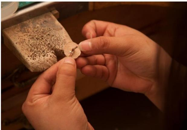
la caja, se pasa el clavo por el cuero y luego por el agujero, entonces se marca el clavo por el otro lado para cortarlo. Se corta con la segueta y se lima el corte, luego se hace un corte para luego hacer como un remache, en mi caso he usado una lima triangular vieja que se coloca en la ranura y se golpea con el martillo para abrir más la ranura y que actúe como remache.
